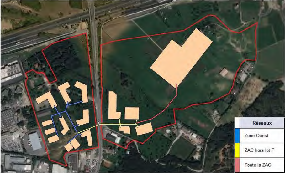
Figure 7 : Tracé du réseau d'un chaleur potentiel sur la ZAC
